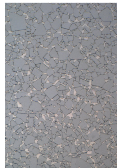
我司某牌号辊环合金相照片 SEM of roll ring
